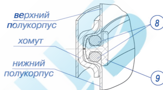
Рис. 3 - Разрез по месту соединения корпусов
