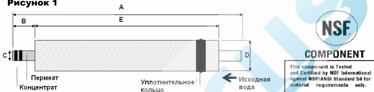
Рис.1. Размеры мембранного элемента.
